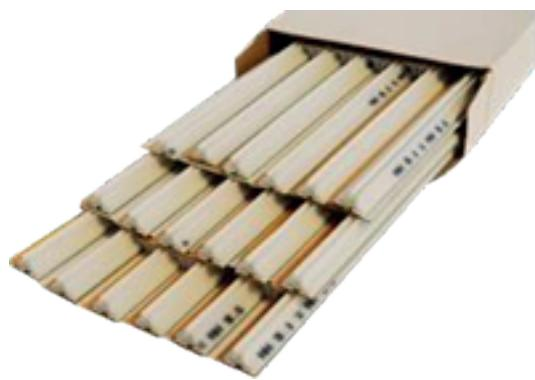
Tiras de hendidura "DURAMATRIX", adecuadas para papel y cartón en sistemas de troquelado y hendidura manual o automático. Se fijan a las planchas o chaquetas de cilindro en las aplicaciones de troquelado y hendidura, actuando como parte de un sistema de "preparación" contra troquel, dentro del cual las matrices de hendidura terminan su recorrido y crean un pliegue en el papel o cartón.
