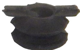
Ítem: 7. Código: PCSFRS40. Diámetro exterior: 16,5 mm. Diámetro interior: 8 mm. Espesor: 9 mm. Unidad de medida: 1.
